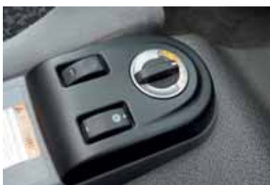
Schakelautomaat De ZF-schakelautomaat kent feitelijk maar twee standen: vooruit of achteruit.
