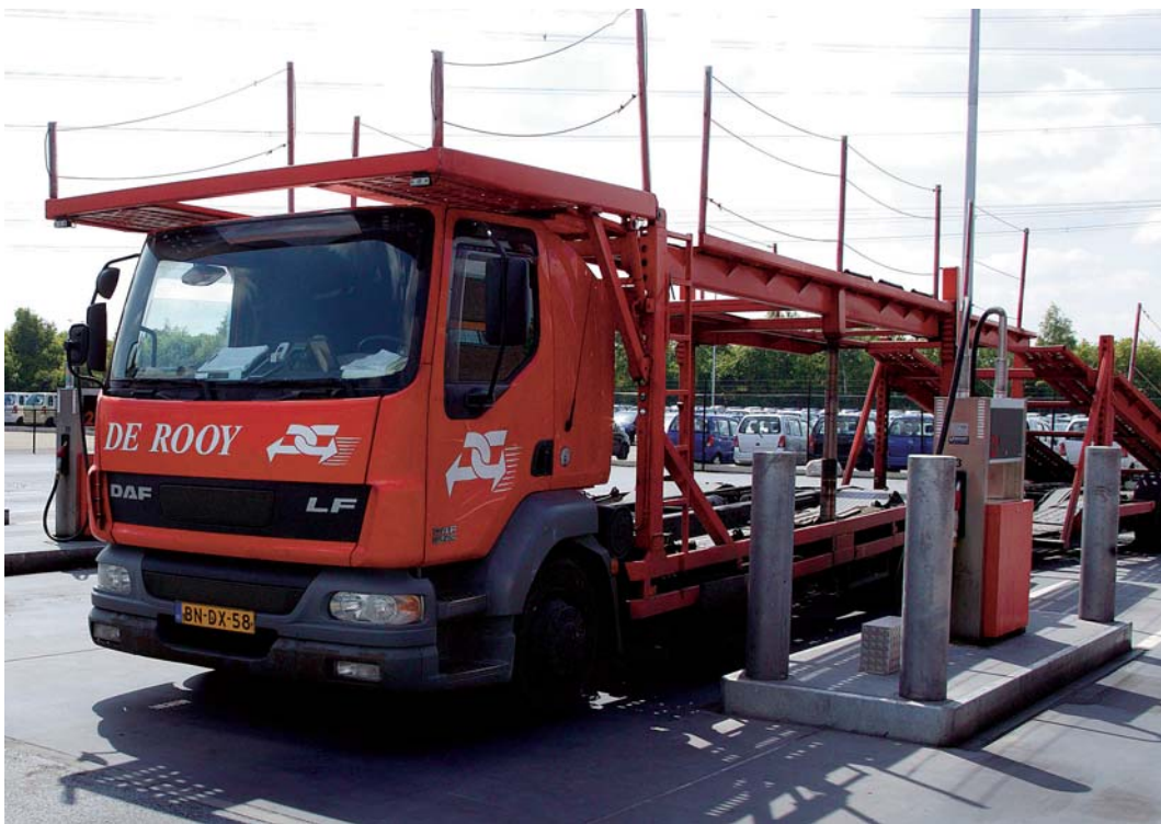
DAF LF Volgens Gerard de Rooy is zijn bedrijf het enige dat de DAF LF inzet als auto-transporteur. Voor regionaal gebruik, motorvermogen 250 pk.
