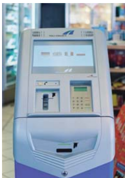
Tankstation Wie geen OBU heeft, dient in te checken bij een terminal op een tankstation.
