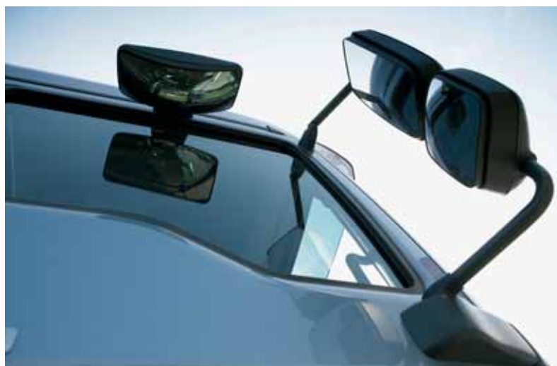
Goed zicht De spiegels zijn niet zo groot dat ze het directe zicht blokkeren maar bieden toch meer dan voldoende uitzicht naar achteren en opzij.
