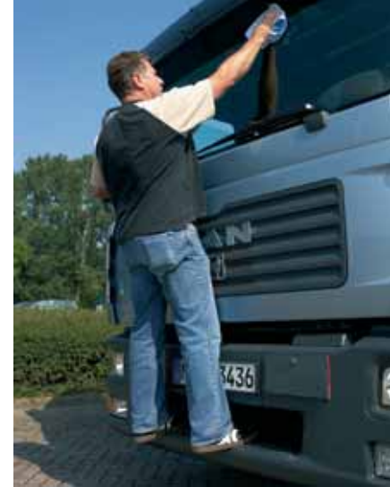
Opstap In de bumper is een richel aangebracht om goed bij de voorruit te kunnen.
