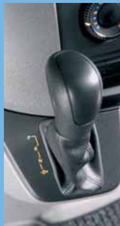
Pook in dashboard De versnellingspook is bij de nieuwe Sprinter weggevoerd in het dashboard.
