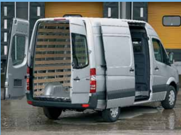
Laadruimte en deuren groter De ruimte tussen de wielkasten werd vergroot, net als de zijschuifdeuren.
