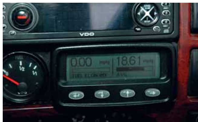
Verbruiksmeter In de middenconsole van de Foden zit een verbruiksmeter van Caterpillar ingebouwd, die in dit geval een droomwaarde aangeeft.
