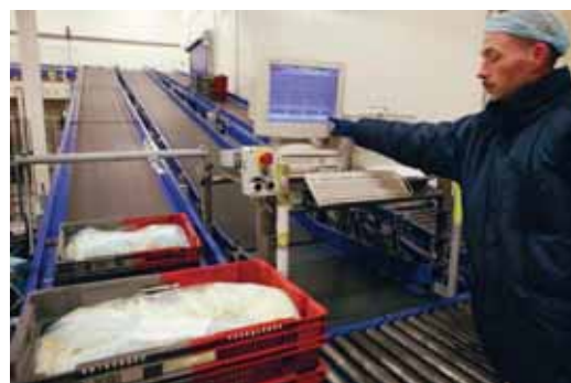
Eindpunt Bij het eindpunt van het Vanderlande systeem, helpt de computer een handje mee in het sorteren van precies de juiste hoeveelheden.
