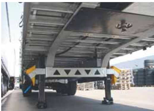
Dwarstraverse De dwarsverbinding is gepatenteerd. Het chassis is standaard vuurverzinkt.
