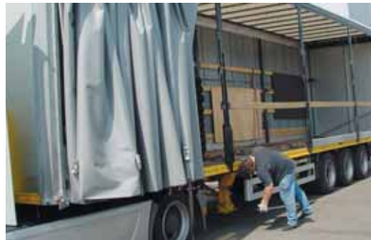
Prototype Op de IAA staat Humbaur met een volumeversie van de Big One. Ook voor deze gebruikt men het Magna Slide-schuifdak, vanwege de geringe kracht die nodig is voor het openen en sluiten.
